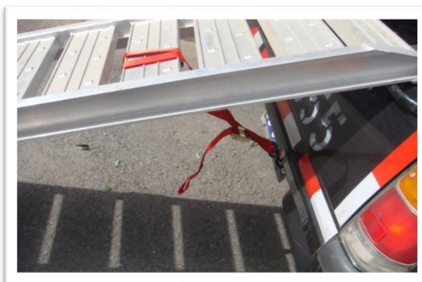
Installation af ramperne
